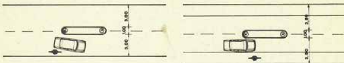
Fig. 34 Door een middengeleider kan een fietser in de knel komen. Er moet gezorgd worden voor voldoende ruimte tussen de heuvel en de stoeprand. Een fietsstrook zorgt ervoor dat auto's beter links zullen houden.
