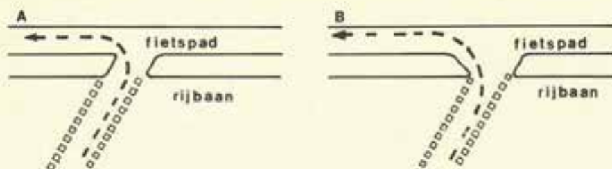
Fig. 25 In situatie A moet een fietser een wel erg krappe bocht nemen. Veel logischer is situatie B. Een beetje nadenken voorkomt een hoop ongemak.
